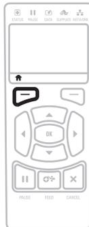
Pressione **SELECIONAR DA ESQUERDA** para voltar ao menu Início. Automaticamente a impressora volta ao menu Início após 15 segundos de inatividade do menu do usuário.
