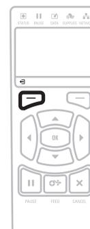
Pressione **SELECIONAR DA ESQUERDA** para sair do menu Início e voltar para o visor ocioso. Automaticamente a impressora volta ao visor ocioso após 15 segundos de inatividade do menu Início.
